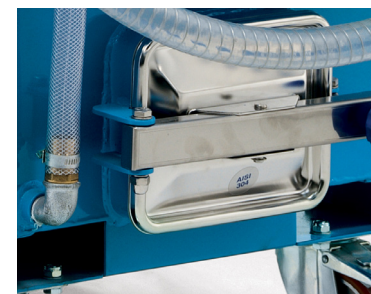
Trou d'homme pour faciliter le nettoyage
