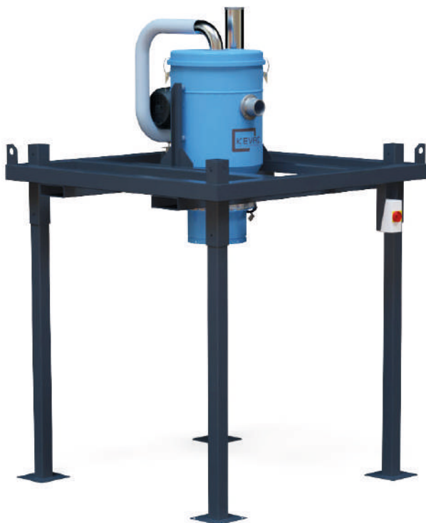
Trémie aspirante pour la collecte de déchets solides (copeaux, poussières etc)
