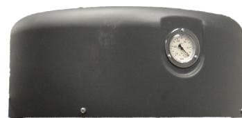
Indicateur de colmatage
