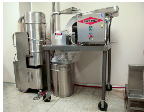
Dépoussiérage de la trémie d'alimentation sur moulin
