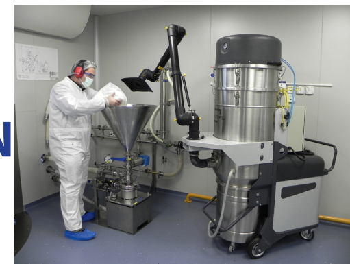
Dépoussiérage de station de dosage par machine ATEX doté de bras et hotte aspirante
