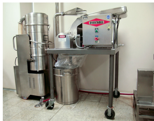
Dépoussiérage de la trémie d'alimentation sur moulin
