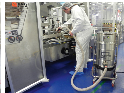
Nettoyage de machine de conditionnement
