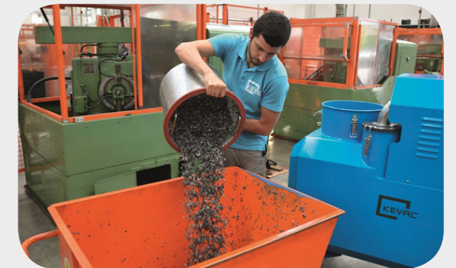
Vidage du panier à copeaux suite au nettoyage d'un centre d'usinage de taillage d'engrenages coniques
