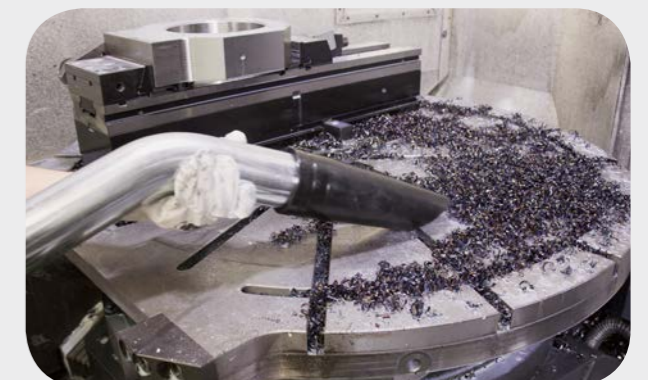
Aspiration de copeaux d'un centre d'usinage multibroche
