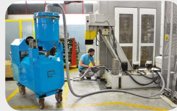
Aspiration de liquide de coupe avec refoulement simultané dans la cuve du centre d'usinage
