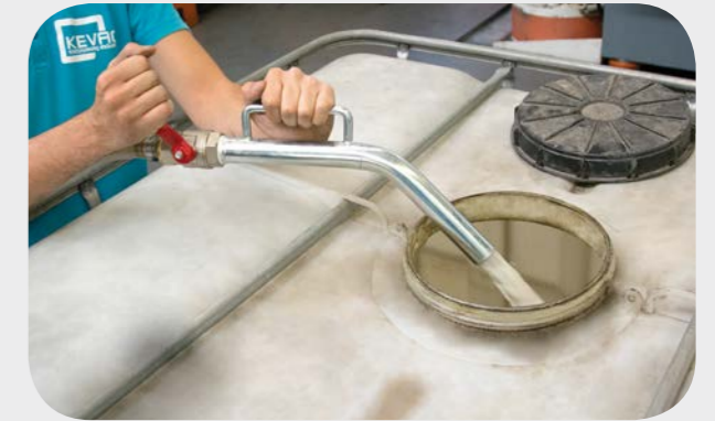
Refoulement de liquide de coupe dans un conteneur approprié
