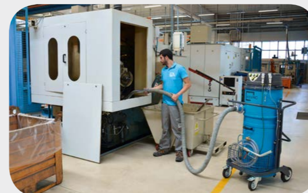
Aspiration de copeaux sur centre d'usinage de taillage d'engrenages coniques
