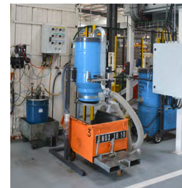
Aspiration avec trémie à ouverture totale collecte déportée dans contenant clients
