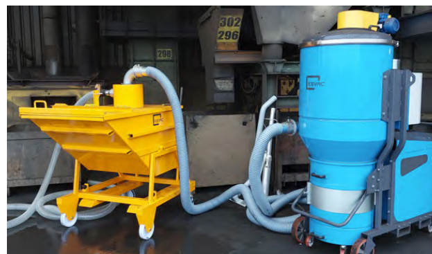
Aspiration de sable avec collecte en benne de 600 litres
