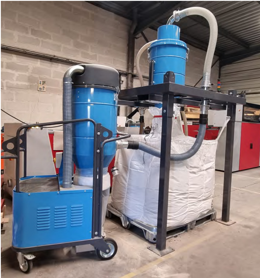
Aspirateur industriel avec filtre absolu, trémie cyclonique, collecte en bigbag, utilisation sur imprimante 3D sable
