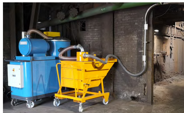
Réseau centralisé pour l'aspiration sur plancher de coulée
