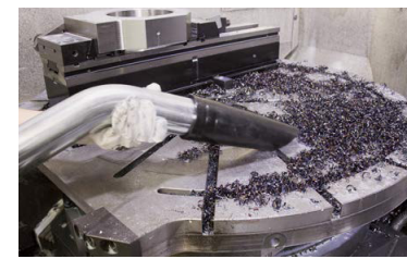
Aspiration de copeaux d'un centre d'usinage multibroche
