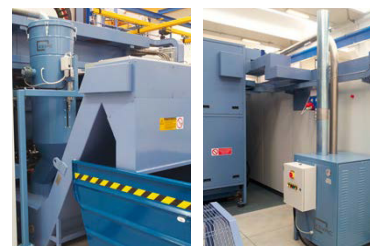
Réseau centralisé pour l'aspiration de copeaux sur plusieurs postes opérateurs avec déchargement automatique sur convoyeur d'évacuation à tapis métallique
